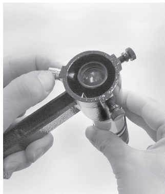
Abbildung 2b. Montieren des Sucherfernrohrs an der dafür vorgesehenen Halterung.
