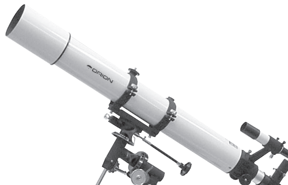
Abbildung 3a. Ausbalancieren des Teleskops auf der RA-Achse. Das Gegengewicht muss entlang der Stange verschoben werden.
