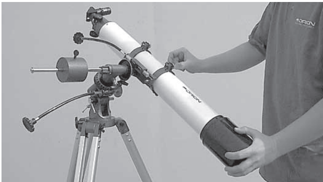
Figura 3d. Equilibrado del telescopio con respecto al eje de declinación. Como se muestra aquí, el telescopio está desequilibrado (inclinación).
