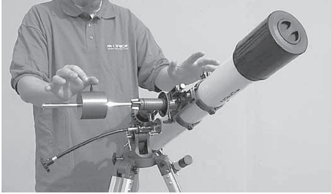
Figura 3b. El telescopio está ahora equilibrado sobre el eje de A. R., es decir, cuando las manos se sueltan, el eje de contrapeso sigue horizontal
