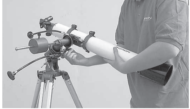
Figura 3c. Preparación del telescopio para equilibrarlo en el eje de declinación liberando antes el botón de bloqueo de declinación.
