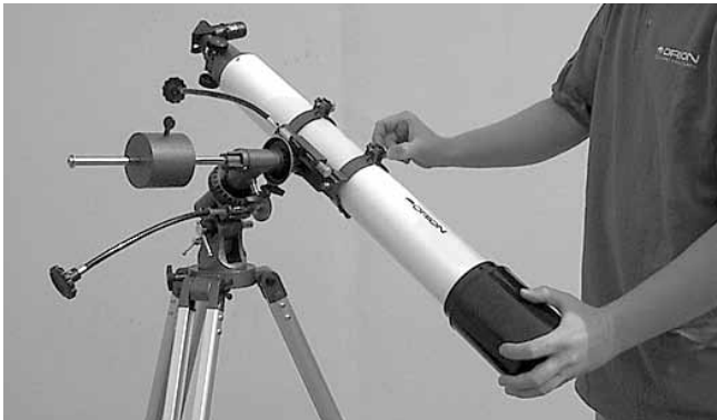
Figure 3d. Équilibrage du télescope par rapport à l'axe de déclinaison. Comme on le voit ici, le télescope est déséquilibré (inclinaison).
