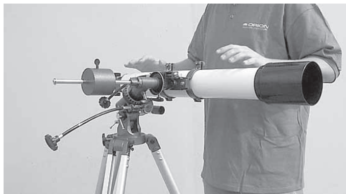
Figura 3e. Il telescopio è in equilibrio sull'asse di declinazione, ossia rimane in posizione orizzontale quando si lascia la presa con le mani.
