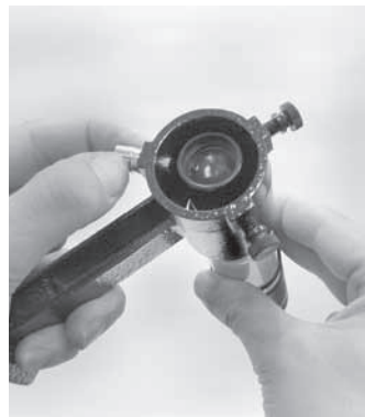
Figura 2b. Inserimento del cercatore nel supporto del cercatore
