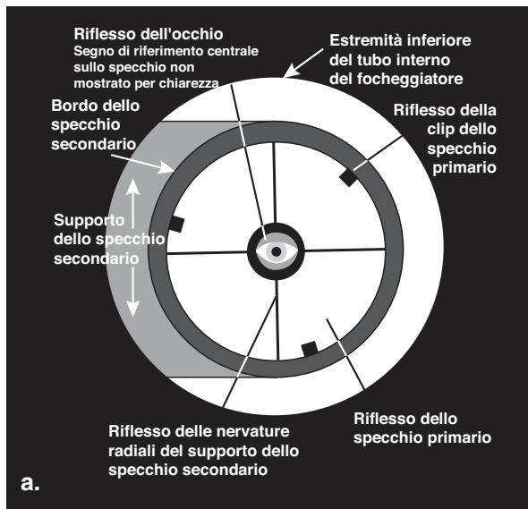
Figura 8. Collimazione delle ottiche. (a) Se gli specchi sono allineati correttamente, l'immagine attraverso il tubo interno del focheggiatore dovrebbe assomigliare a quella illustrata. (b) Con il tappo di collimazione applicato, se l'ottica non è allineata, l'immagine potrebbe assomigliare a quella illustrata. (c) In questo caso lo specchio secondario è centrato sotto il focheggiatore, ma deve essere regolato (inclinato) in modo che l'intero specchio primario sia visibile. (d) Lo specchio secondario è allineato correttamente, ma lo specchio primario ha ancora bisogno di regolazione. Quando lo specchio primario è allineato correttamente, il punto risulta centrato, come in (e).
