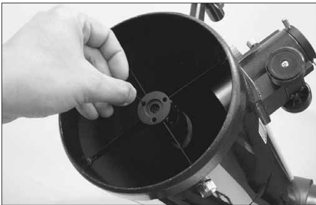
Figure 15. Ajustez l'inclinaison du miroir secondaire en desserrant ou en serrant les trois vis d'alignement à l'aide d'une clé hexagonale de 2 mm.
