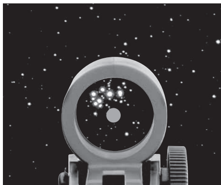
Figura 7. Il mirino EZ Finder II proietta un minuscolo puntino rosso nel cielo, mostrando esattamente dove è puntato il telescopio.
