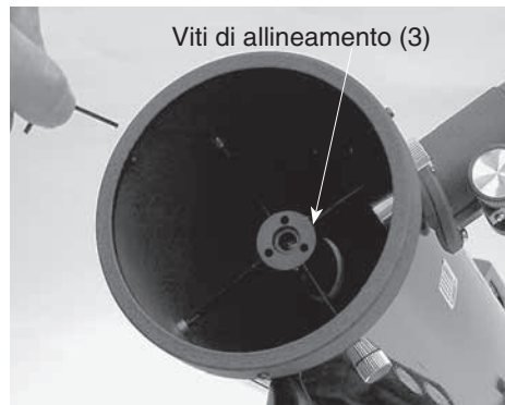
Figura 10. Regolare l'inclinazione dello specchio secondario allentando o stringendo le tre viti di allineamento con una chiave esagonale da 2 mm.
