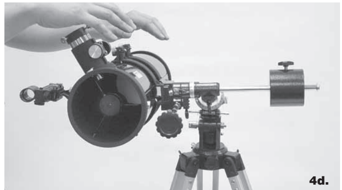
Figura 4. Per un corretto utilizzo della montatura equatoriale, il tubo del telescopio deve essere in equilibrio su entrambi gli assi di ascensione retta e declinazione. (a) Con la manopola di blocco dell'ascensione retta non serrata, fare scorrere il contrappeso lungo la barra fino a controbilanciare il tubo. (b) Se si lascia andare il tubo con entrambe le mani, non deve spostarsi verso l'alto o il basso. (c) Con la manopola di blocco della declinazione non serrata, allentare di alcuni giri i morsetti di blocco degli anelli del tubo e fare scorrere il telescopio in avanti o indietro negli anelli. (d) Se il tubo è in equilibrio sull'asse di declinazione, non si sposterà quando viene lasciato andare.
