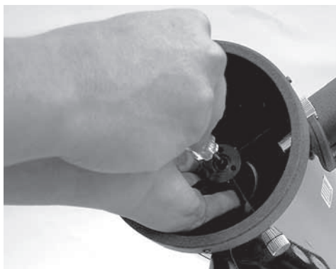
Figura 10. Per centrare lo specchio secondario sotto il foceggiatore, mantenere in posizione il supporto dello specchio secondario con le dita mentre si regola la vite centrale con un cacciavite a croce. Non toccare la superficie dello specchio.
