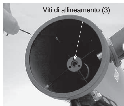
Figura 11. Per centrare lo specchio secondario in altezza nel tubo interno del foceggiatore, regolare i due dadi zigrinati delle nervature radiali perpendicolari al foceggiatore.
