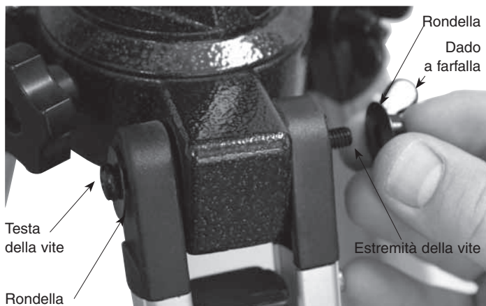
Figura 2. Fissare le gambe del treppiede alla montatura con le viti in dotazione installate in cima alle gambe del treppiede. Mettere una rondella tra la testa della vite e la gamba del treppiede e mettere un'altra rondella tra il dado a farfalla e la gamba del treppiede.
