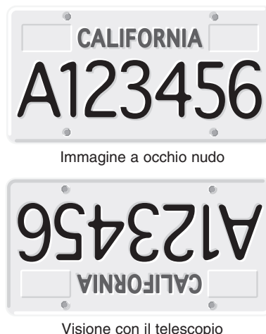
Figura 6. La visione con un telescopio riflettore è ruotata di 180°
