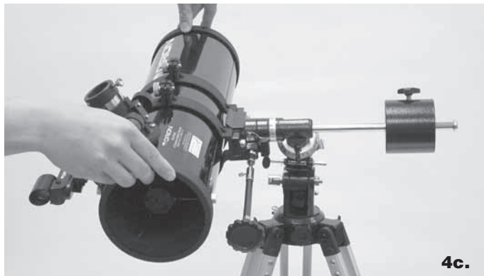
Figura 4. Per un corretto utilizzo della montatura equatoriale, il tubo del telescopio deve essere in equilibrio su entrambi gli assi di ascensione retta e declinazione. (a) Con la manopola di blocco dell'ascensione retta non serrata, fare scorrere il contrappeso lungo la barra fino a controbilanciare il tubo. (b) Se si lascia andare il tubo con entrambe le mani, non deve spostarsi verso l'alto o il basso. (c) Con la manopola di blocco della declinazione non serrata, allentare di alcuni giri i morsetti di blocco degli anelli del tubo e fare scorrere il telescopio in avanti o indietro negli anelli. (d) Se il tubo è in equilibrio sull'asse di declinazione, non si sposterà quando viene lasciato andare.
