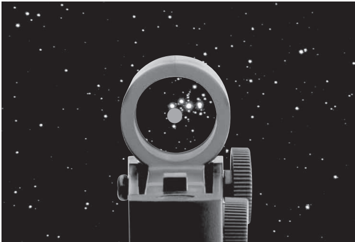
Figure 3. Le EZ Finder II superpose un petit point rouge sur le ciel, indiquant l'endroit où le télescope est pointé.
